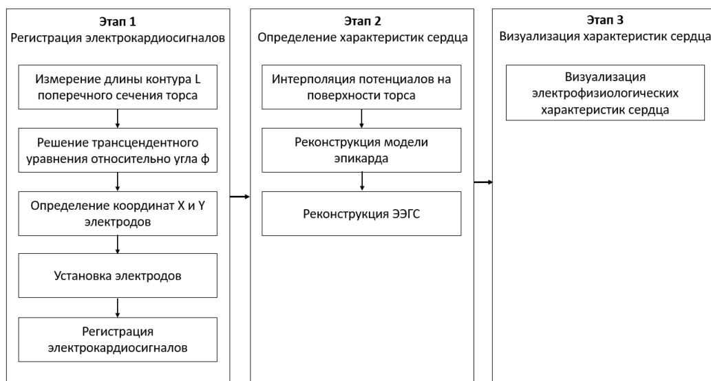
Рисунок 6. Алгоритм работы программно-аппаратного комплекса
